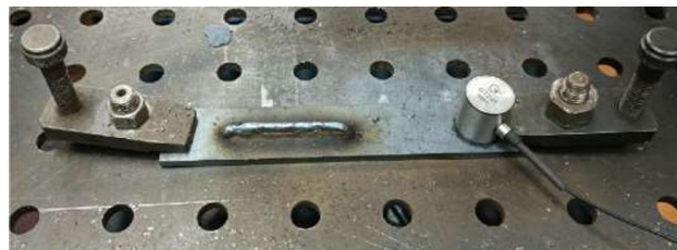
Рис. 2. Пример печати образца с регистрацией сигнала АЭ Fig. 2. Example of specimen printing with acoustic emission signal recording
