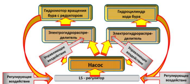
Рис. 3. Схема системы регулирования гидропривода бурового инструмента
