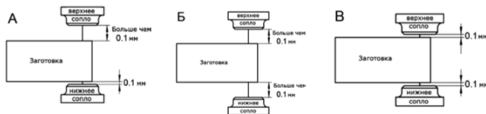
Рис. 2. Схематичное расположение сопел при проволочно-вырезной электроэрозионной обработке: а – в режиме «OPEN U»; б – в режиме «OPEN»; в – в режиме «CLOSE»
