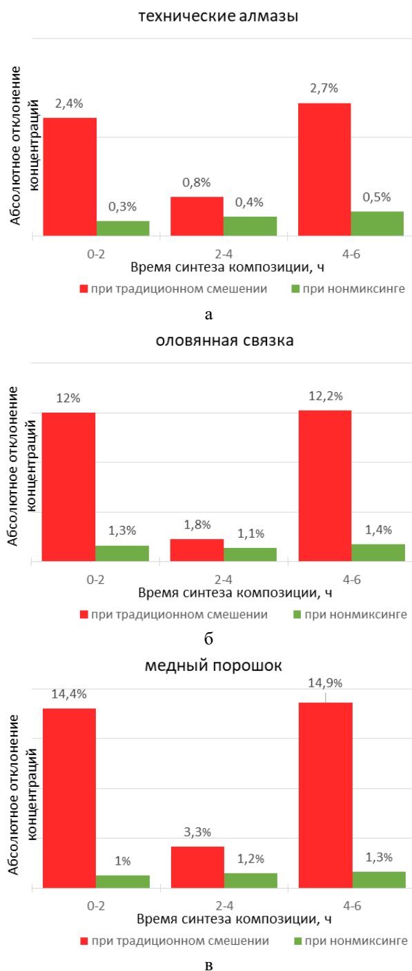
Рис. 5. Предельные отклонения содержания компонентов в образцах инструментальных композитов: а – алмазы; б – олово; в – медь
