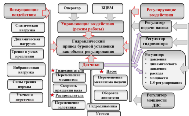
Рис. 4. Схема объекта регулирования – гидропривода буровой установки
