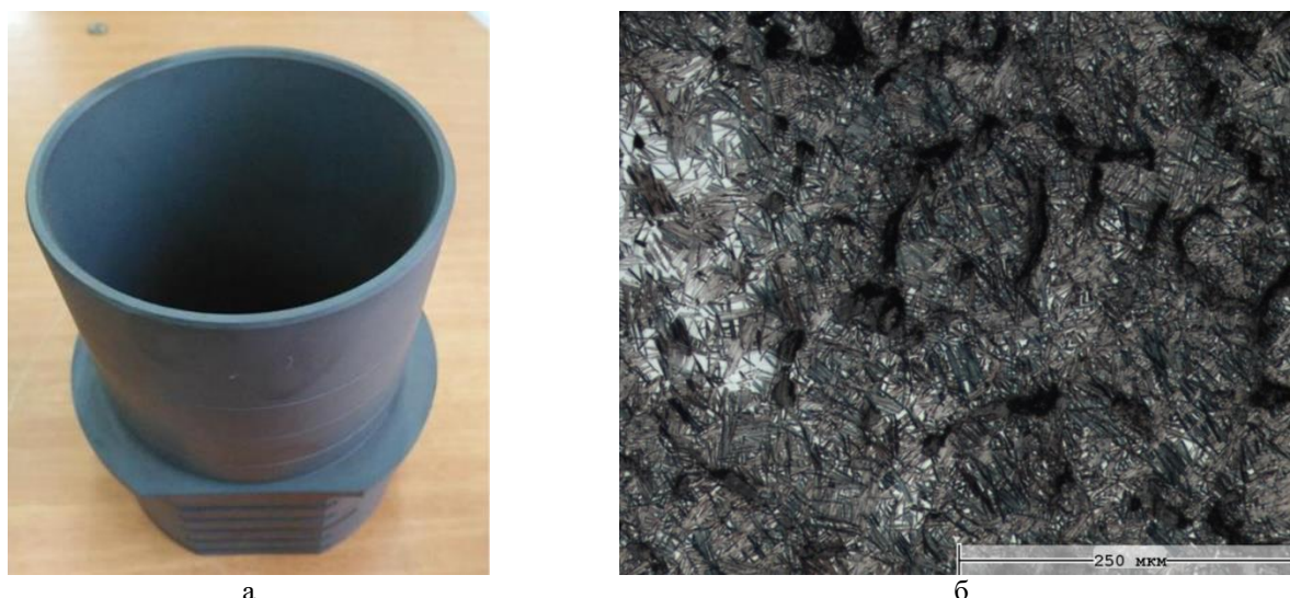
Рис. 1. Опытная деталь «Гильза авиационного двигателя» после изотермической закалки: а – внешний вид; б – микроструктура, \times 190 , травлено 4% \text{HNO}_3 Fig. 1. Experimental component “Aircraft engine cylinder liner” after austempering: a is general view; б is microstructure, \times 190 , etched with 4% \text{HNO}_3
