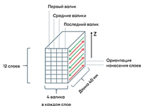
Рис. 9. Схема выращивания технологических проб Fig. 9. Scheme of manufacturing technological test specimens
