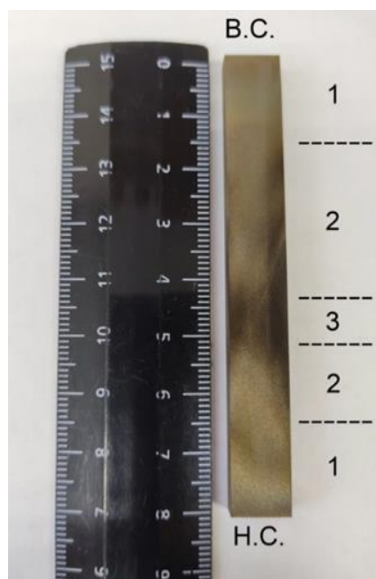
Рис. 8. Выпадающая часть образца стали 5XhNM, обработанного в режиме «CLOSE»: В.С. – положение верхнего сопла, Н.С. – положение нижнего сопла
