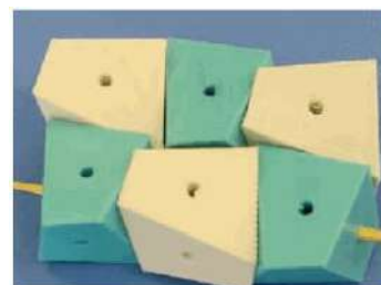
Рис. 3. Принцип расположения (сборки) блоков в слое
