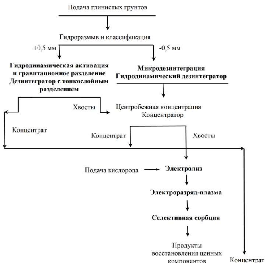
Рис. 3. Технологическая схема переработки техногенных высокоглинистых песков
