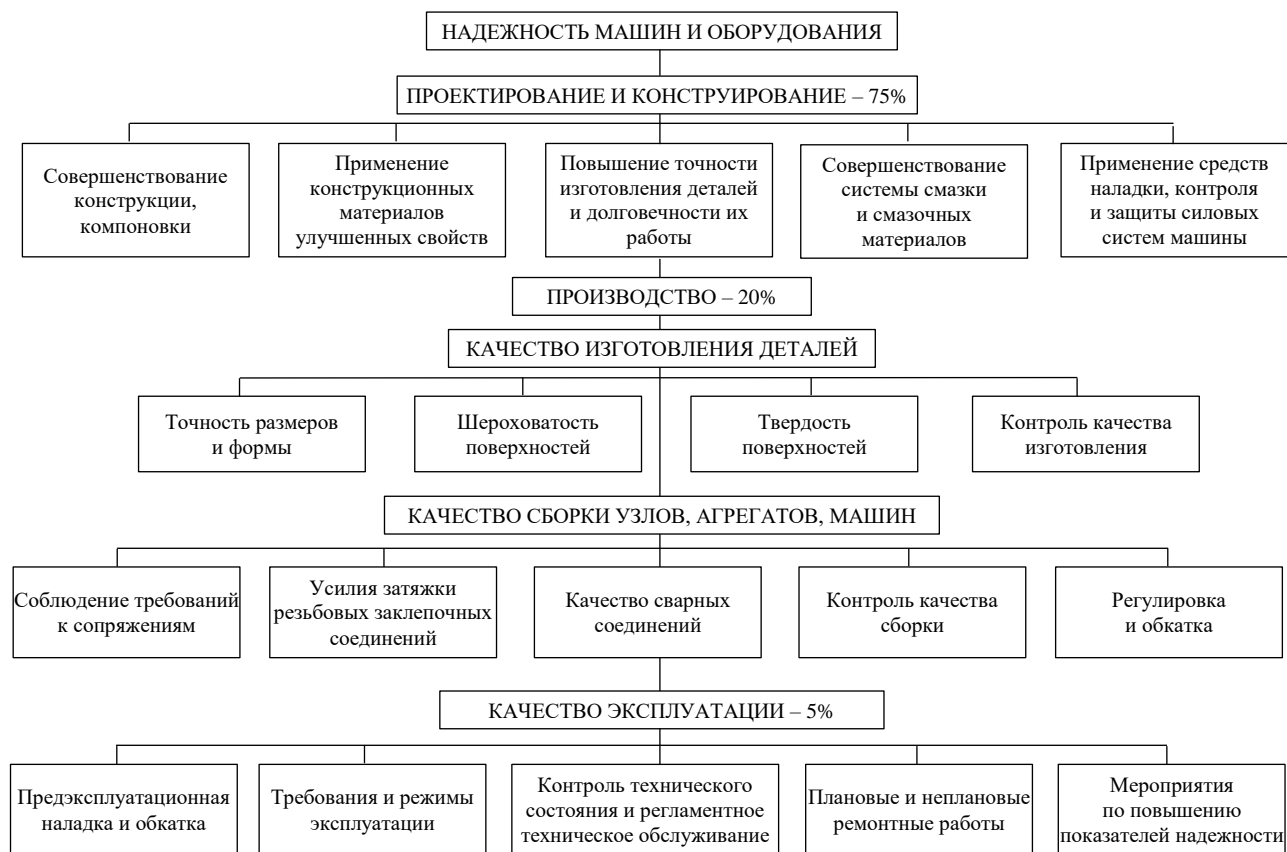
Рис. 4. Обеспечение качества изделий машиностроения на этапах жизненного цикла
