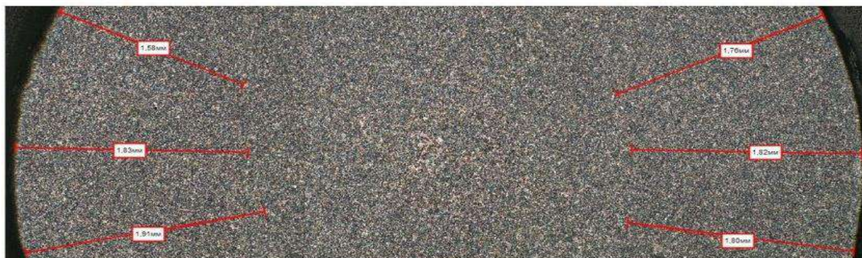
Рис. 3. Микроструктура катанки из стали ШХ15 диаметром 6,5 мм, \times 500 Fig. 3. Microstructure of wire rod from steel ShH15 with a diameter of 6,5 mm, \times 500
