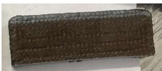
Рис. 1. Внешний вид наплавленной стенки
