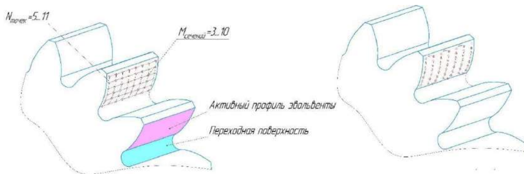
Рис. 2. Формирование сеток контрольных точек при координатном контроле [4]
