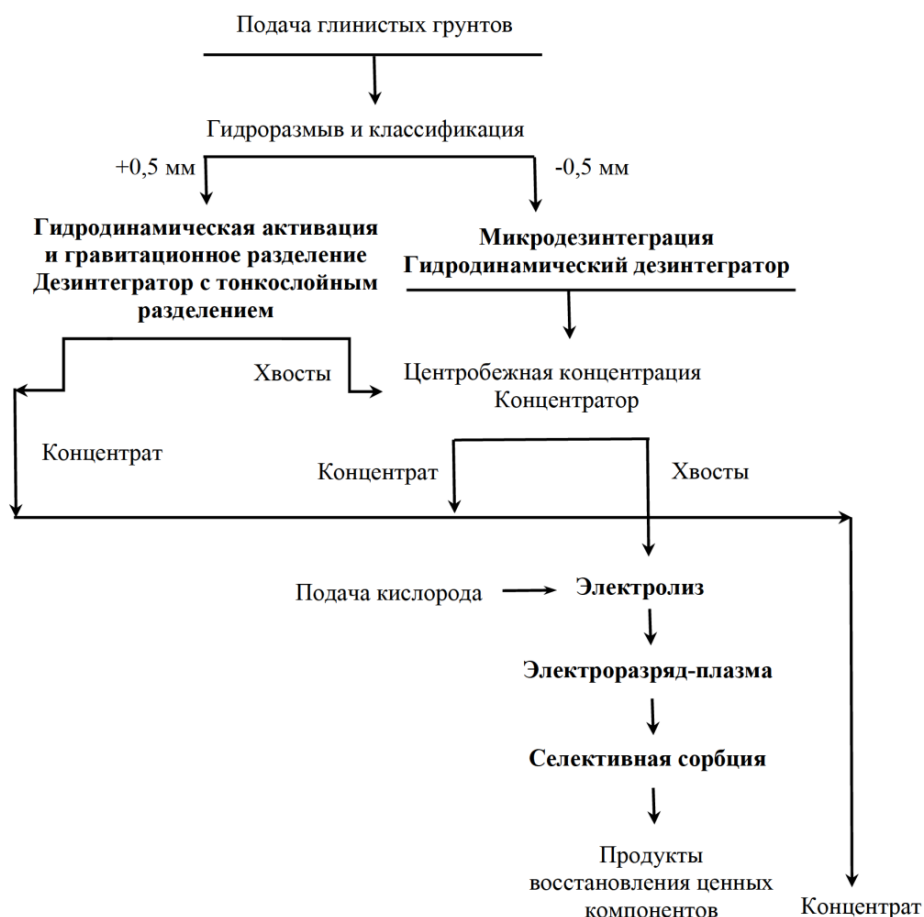
Рис. 3. Технологическая схема переработки техногенных высокоглинистых песков Fig. 3. Technological scheme for the processing man-made high-clay sands
