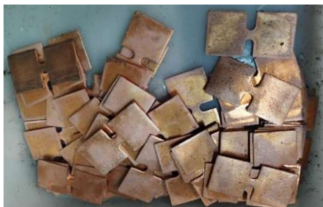
Рис. 5. Штамповая оснастка из ПЛА (укрупненно) Fig. 5. Stamping unit made of PLA (magnified)
