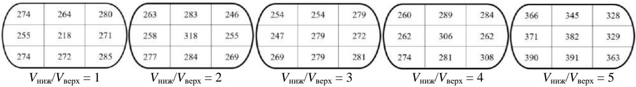
Рис. 4. Твердость по сечению образцов после прокатки Fig. 4. Hardness across the cross-section of samples after rolling
