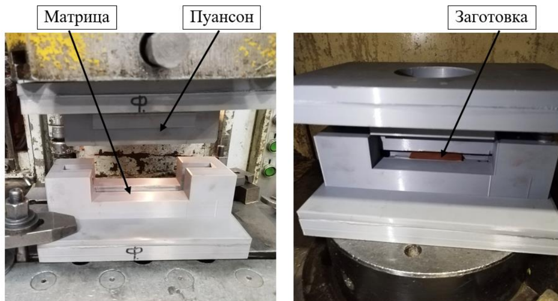
Рис. 5. Штамповая оснастка из ПЛА (укрупненно) Fig. 5. Stamping unit made of PLA (magnified)
