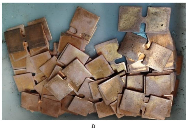
Рис. 6. Заготовки до штамповки (а) и после деформации (б) Fig. 6. Blanks before stamping (a) and after deformation (б)
