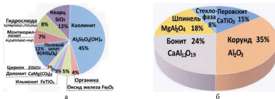
Рис. 2. Минералогический состав отходов производств: а – ГЦИ; б – шлак от выплавки ферротитана Fig. 2. Mineralogical composition of industrial waste: a is GZI; b is ferro-titanium slag
