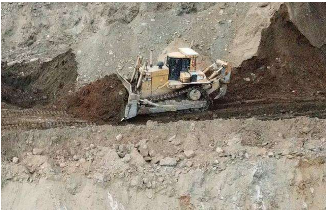
Рис. 1. Пример работы бульдозера CAT D9R в нормальном забое
