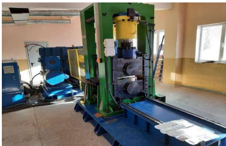
Рис. 1. Реверсивный стан дуо листовой прокатки с индивидуальным приводом рабочих валков
