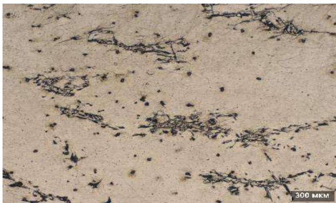
Рис. 5. Очаги рекристаллизации в образце №2 (оптическая микроскопия)
