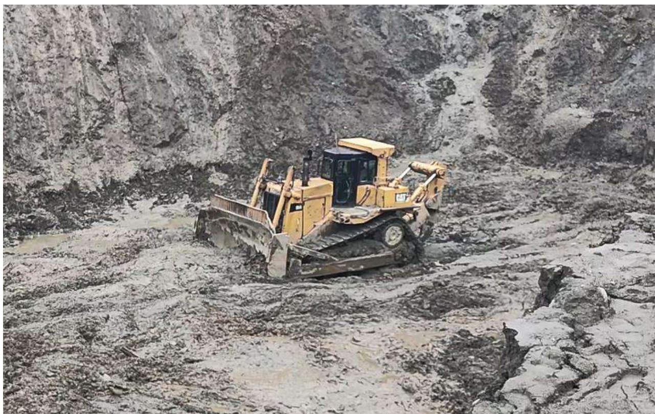
Рис. 2. Пример работы бульдозера CAT D9R в обводнённом забое
