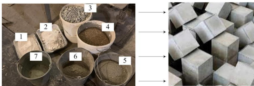
Рис. 1. Вид материалов и изготовленных образцов: 1, 2 – модификатор бетона «Эмбэлит»; 3 – щебень; 4 – песок мытый; 5, 6 – портландцемент; 7 – вода питьевая с пластификатором Fig. 1. Materials and manufactured samples: 1, 2 is Embelit concrete modifier; 3 is gravel; 4 is washed sand; 5, 6 is Portland cement; 7 is drinking water with a plasticizer
