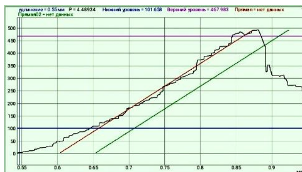
Рис. 4. Диаграмма сжатия образца ВЖ 159 при 670°C Fig. 4. Compression diagram of the specimen of VZh159 at 670°C
