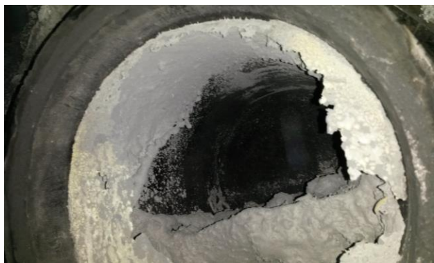
Рис. 6. Продукт, полученный в реакторе после отгонки цинка и вторичной деструкции
