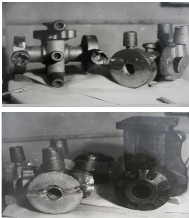
Рис. 1. Внешний вид отливок с экзотермическими прибылями
