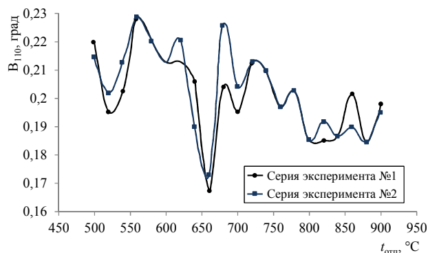
Рис. 3. Зависимость усредненного по трем точкам уширения дифракционных максимумов линии 110 ( B_{110} ) от температуры отпуска чистого железа. Серия эксперимента №1 и 2
