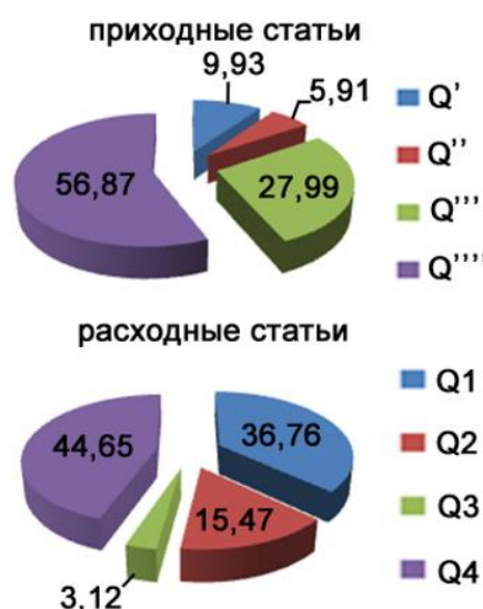
Рис. 7. Баланс тепловой работы захолаживаемой и утепляющей прибыльных надставок: Q' – теплота, выделившаяся при охлаждении расплава от температуры разливки до температуры ликвидус; Q'' – теплота, выделившаяся при охлаждении металла от температуры ликвидус до температуры солидус; Q''' – теплота, выделившаяся при охлаждении металла от температуры солидус до средней температуры металла в прибыли на момент окончания процесса; Q'''' – скрытая теплота кристаллизации; Q_1 – количество тепла, расходуемого на нагрев футеровочных материалов и корпуса прибыльной надставки; Q_2 – количество тепла, излучаемого с наружной поверхности прибыльной части изложницы; Q_3 – количество тепла, излучаемого через зеркало металла прибыльной части слитка; Q_4 – количество тепла, переданного телу слитка
