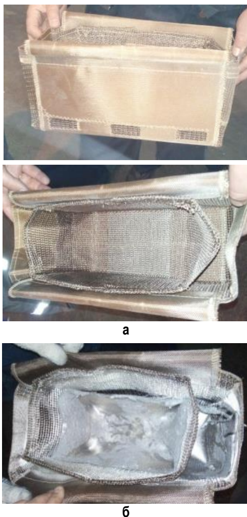
Рис. 7. Термоформованные распределители металла (Combo-bag): а – новый; б – после литья
