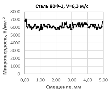
Рис. 6. Распределение микротвердости по сечению проволоки для стали 80Ф-1
