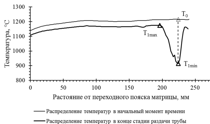
Рис. 2. Изменение температурного поля заготовки
