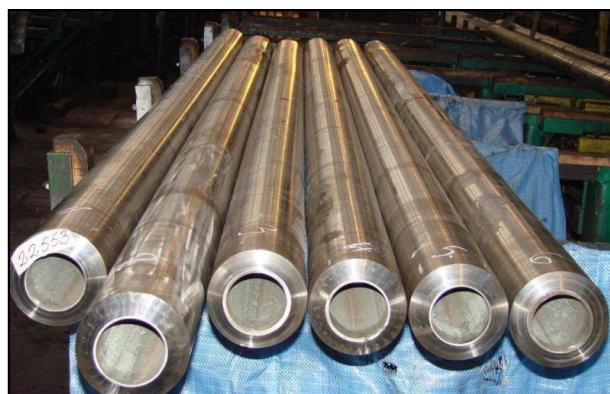
Рис. 5. Трубы размером 146,0×30,0 из сплава марки ТМК-С (после обточки и зачистки)
