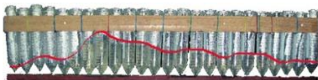
Рис. 13. Измерительная планка для определения распределения охладителя в области орошения форсунок
