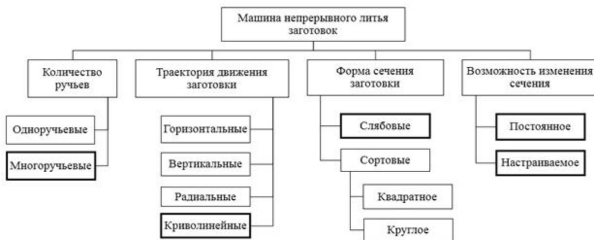
Рис. 1. Схема классификации машин непрерывного литья заготовок
