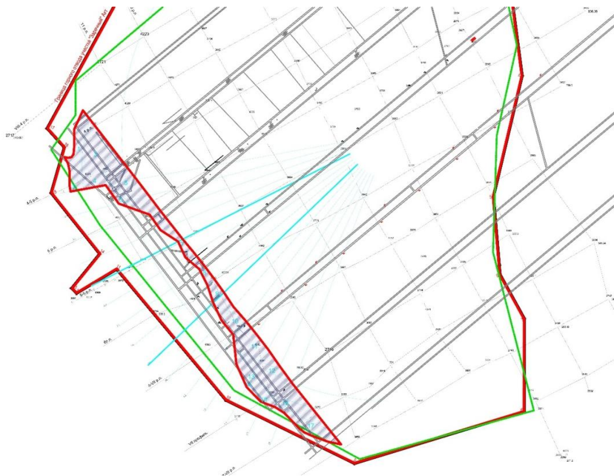
Рис. 4. Месторасположение целика для обеспечения безопасности подземных работ
