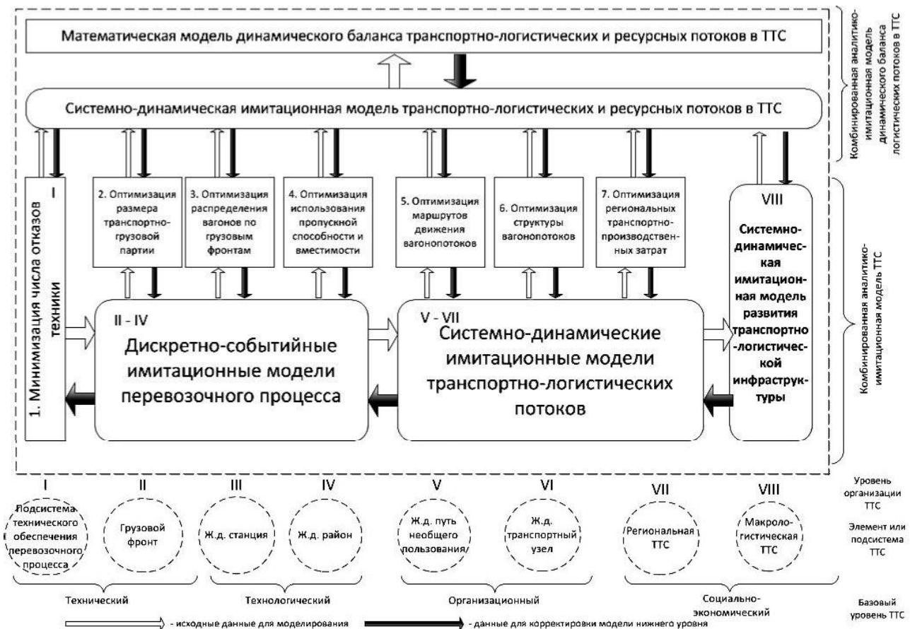
Рис. 2. Схема взаимосвязи блоков комбинированной аналитико-имитационной модели ТТС
