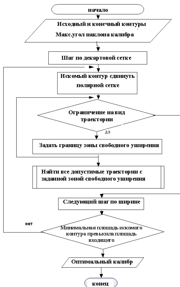
Рис. 2. Блок-схема алгоритма численного решения задачи оптимизации формы калибра
