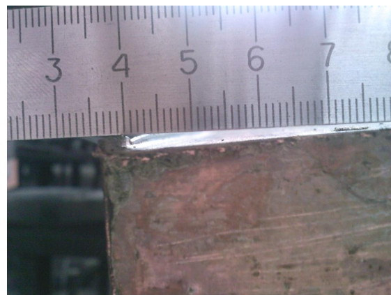
Рис. 3. Замер износа медной стенки при помощи поверочной линейки
