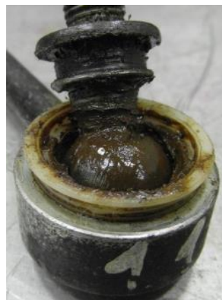
Рис. 2. Внешний вид зарекомендованного шарнира стойки стабилизатора
