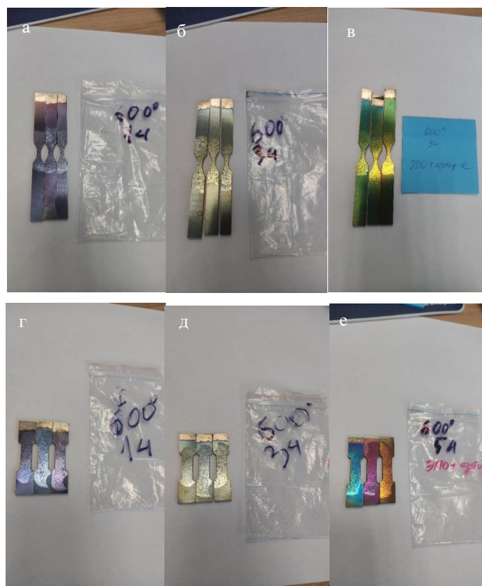
Рис. 1. Фотография внешнего вида образцов после электронно-пучкового и ионно-плазменного воздействия при температуре 600°C и времени азотирования 1, 3 и 5 ч: а, б, в – образцы для испытаний на усталость (1-я партия); г, д, е – образцы для механических испытаний (2-я партия)
