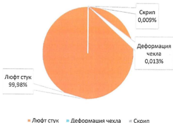
Рис. 1. Распределение типов дефектов шарниров стойки стабилизатора автомобиля LADA Vesta Fig. 1. Distribution of defect types of the stabilizer link joints of the LADA Vesta car
