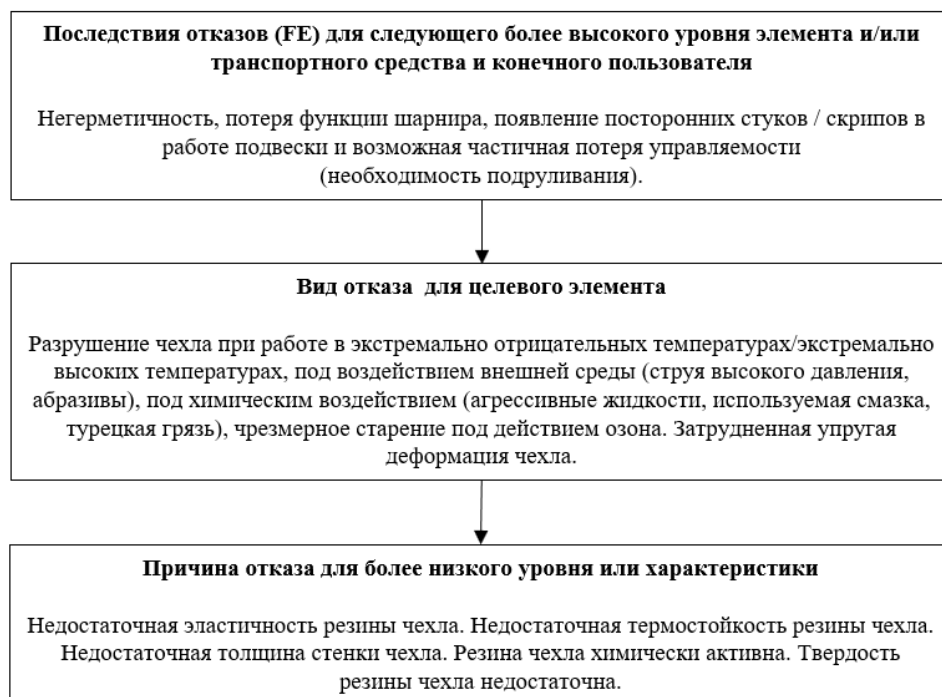
Рис. 3. Выявление корневых причин негерметичности посредством DFMEA-анализа Fig. 3. Identifying root causes of leaks using DFMEA Analysis
