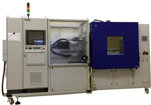
Рис. 4. Испытательный стенд для проверки герметичности шаровых шарниров
