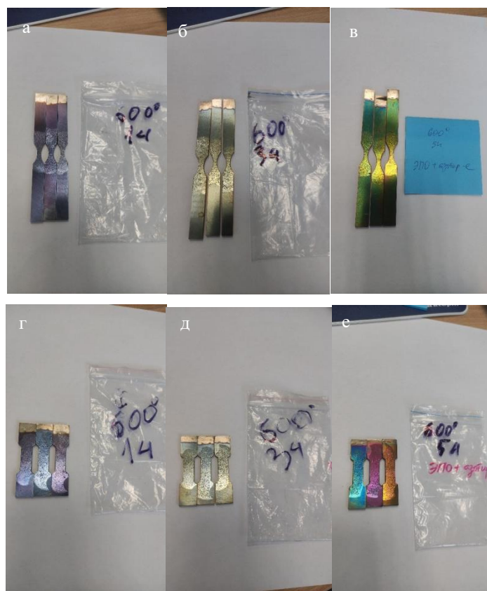
Рис. 1. Фотография внешнего вида образцов после электронно-пучкового и ионно-плазменного воздействия при температуре 600°C и времени азотирования 1, 3 и 5 ч: а, б, в – образцы для испытаний на усталость (1-я партия); г, д, е – образцы для механических испытаний (2-я партия) Fig. 1. An image of the samples after electron beam treatment and ion plasma exposure at a temperature of 600°C and a nitriding time of 1, 3 and 5 hours: а, б, в are fatigue test samples (1st batch); г, д, е are samples for mechanical tests (2nd batch)
