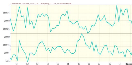
Рис. 3. PtSC-записи аппаратуры ZETLAB по оценке точек напряженно-деформированного состояния в элементах рабочего оборудования
