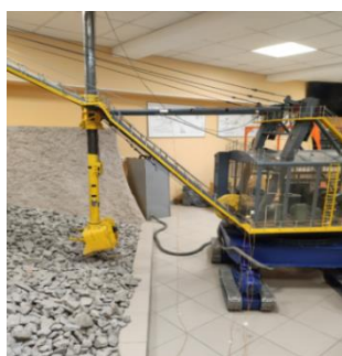
Рис. 2. Визуализация лабораторных экспериментальных исследований: а – действующая модель карьерного экскаватора (кафедра ГМК ФГБОУ ВО «УГТУ»); б – программно-аппаратный комплекс
