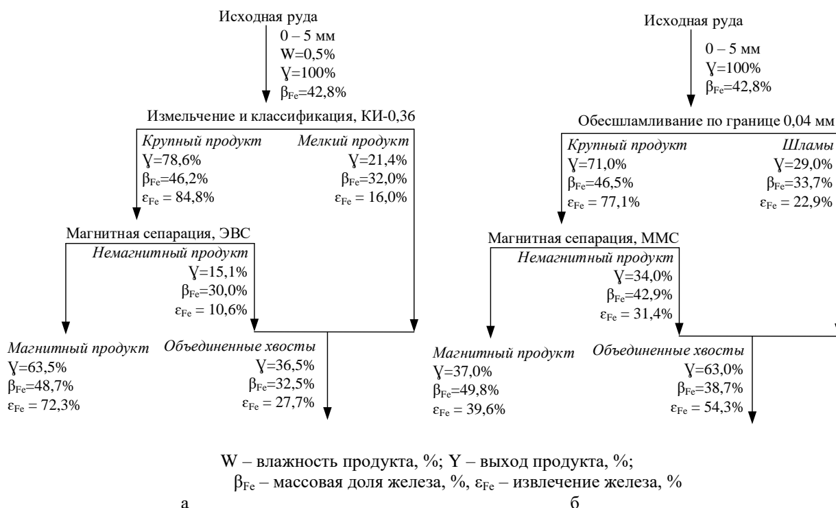
Рис. 5. Показатели переработки бурожелезняковой руды по схемам сухого (а) и мокрого (б) обогащения Fig. 5. Indicators of processing of brown clay iron ore according to dry (a) and wet (б) enrichment schemes
