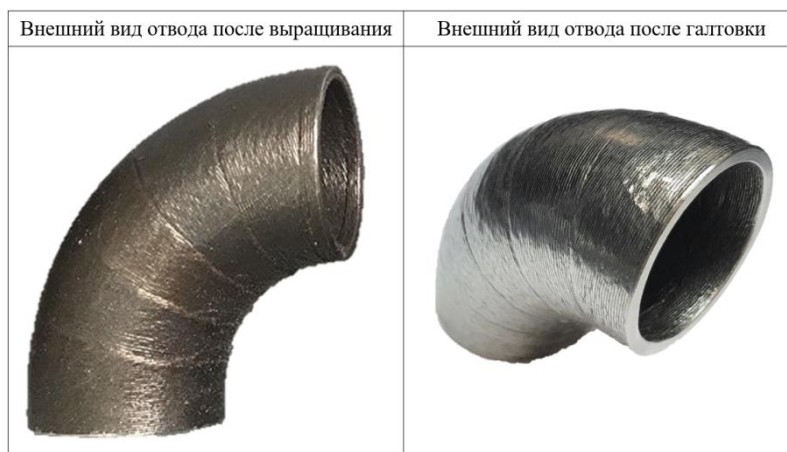
Рис. 8. Поверхностный слой изделия до и после обработки Fig. 8. The surface layer of the branch tube before and after processing
