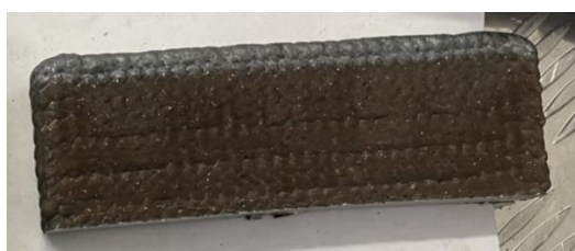
Рис. 1. Внешний вид напавленной стенки Fig. 1. External view of the deposited wall
