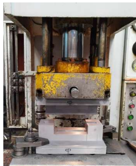
Рис. 4. Гидравлический пресс с установленной штамповой оснасткой из ПЛА Fig. 4. Hydraulic press with the stamping unit made of PLA
