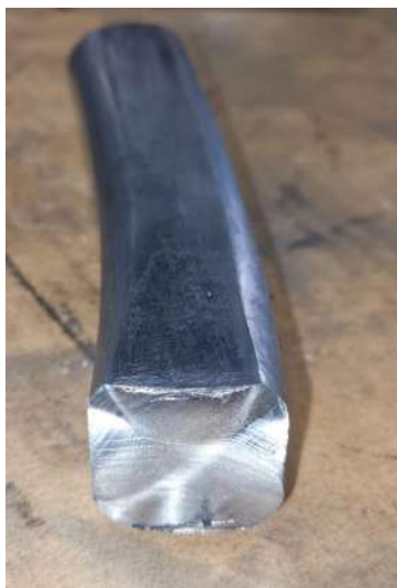
Рис. 5. Квадратная заготовка, полученная после прокатки круга на гладкой бочке в два прохода с кантовкой
