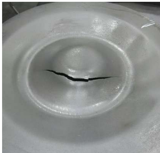
Рис. 7. Разрушение заготовки в точке 2 на первом переходе штамповки
