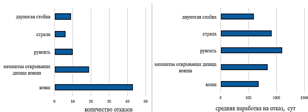
Рис. 3. Анализ показателей надёжности рабочего оборудования по парку карьерных экскаваторов Fig. 3. Analysis of reliability indicators of the working equipment across the quarry excavator fleet
