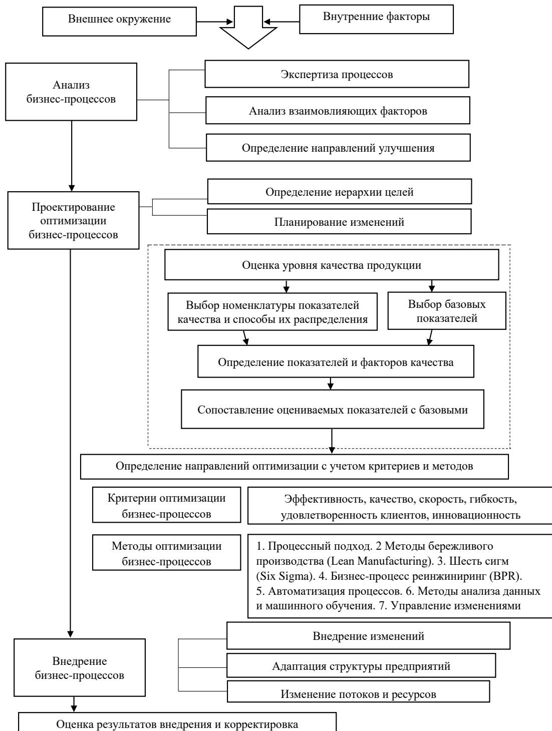
Рисунок. Алгоритм оптимизации бизнес-процессов на основании многофакторного анализа качества продукции машиностроения (составлено авторами)
