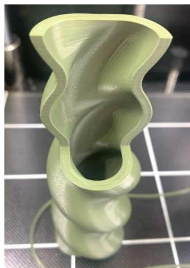
Рис. 13. Корпус обоймы в разрезе, напечатанный на 3D-принтере Fig. 13. Sectional view of the 3D printed cage
