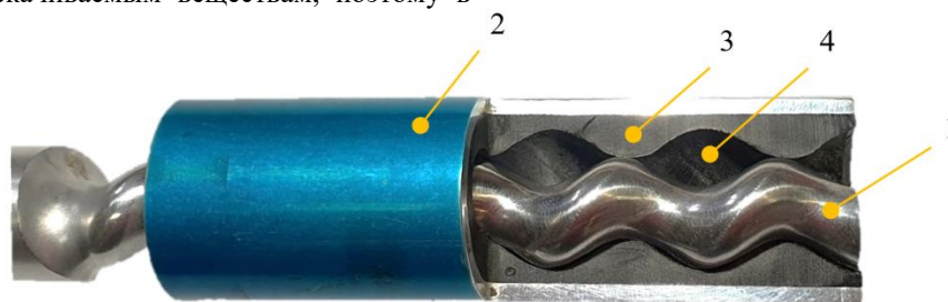
Рис. 1. Одновинтовая пара: 1 – ротор; 2 – корпус обоймы; 3 – эластомерный слой обоймы; 4 – внутренняя циклоидальная винтовая поверхность
