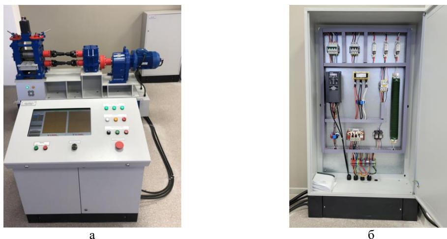
Рис. 2. Пульт (а) и шкаф (б) управления стана ДУО-130 Fig. 2. The control panel (a) and an automation cabinet (б) of duo rolling mill 130
