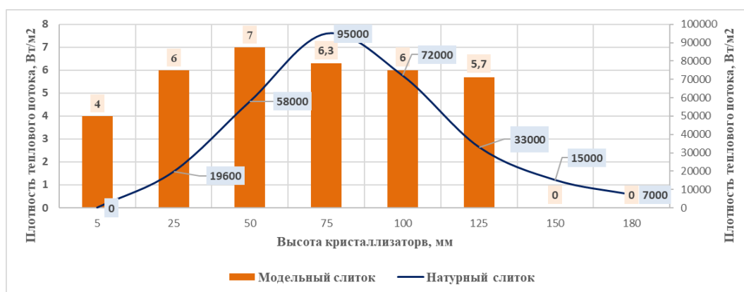
Рис. 2. Зависимость плотности теплового потока по высоте кристаллизатора Fig. 2. Dependence between heat flux density and mold height
