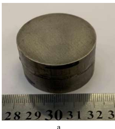
Рис. 2. Заготовка из титанового сплава ОТ4-1 до (а) и после (б) осадки с кручением при комнатной температуре (толщина пакета 5,2 мм)
