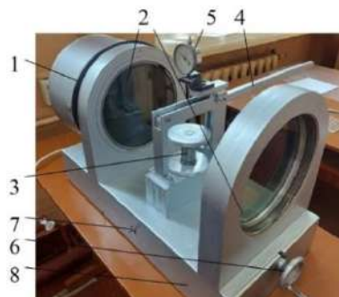
Рис. 4. Полярископ: 1 – источник света; 2 – поляроиды; 3 – винтовой домкрат; 4 – нагрузочное устройство рычажного типа; 5 – индикатор часового типа; 6 – устройство для относительного поворота поляроидов; 7 – электровыключатель; 8 – корпус
