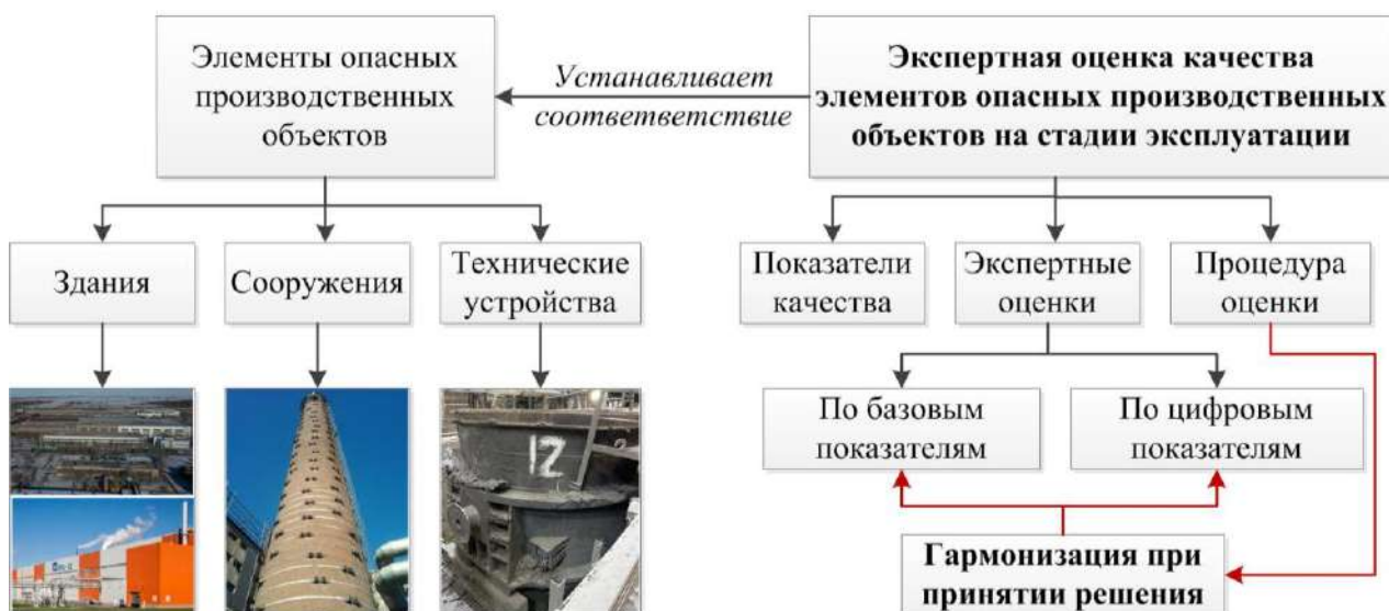
Рис. 2. Схема процессов мониторинга и оценки соответствия технического состояния элементов ОПО Fig. 2. Diagram of the processes of the monitoring and compliance assessment of the technical condition of the HPF elements
