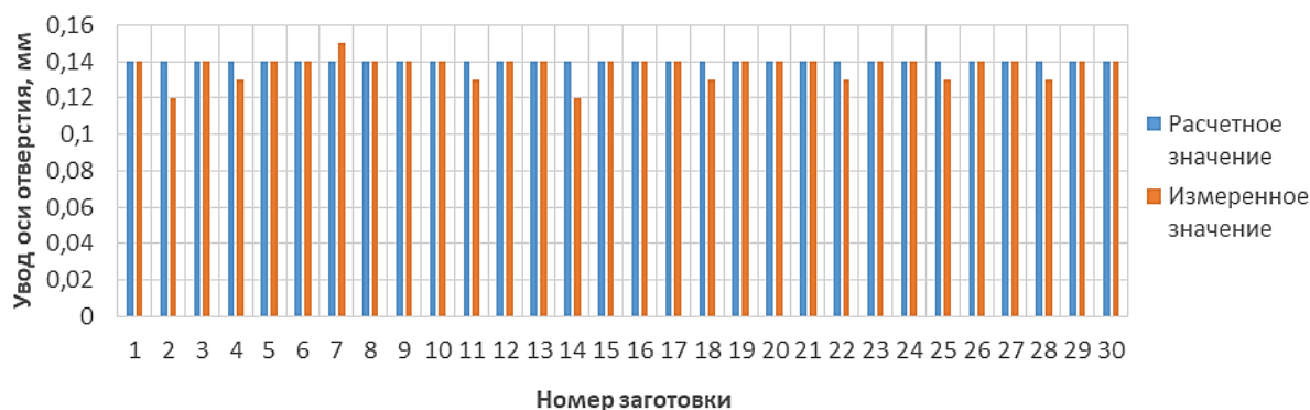
Рис. 12. Результаты измерений увода оси отверстия после сверления сверлом диаметром 5 мм (сталь ШХ15) Fig. 12. Measurement results of the hole axis deflection after drilling with a drill, 5 mm in diameter (steel ШХ15)
