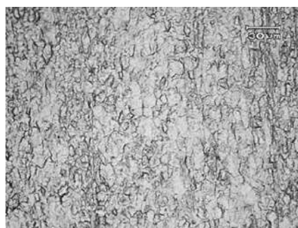
Рис. 7. Структура исходного образца сплава ОТ4-1 при температуре 20°C до нагрева под проведение осадки с кручением, увеличение ×100 Fig. 7. The structure of the initial sample of alloy OT4-1 at 20°C before its heating for upsetting with torsion, ×100 magnification
