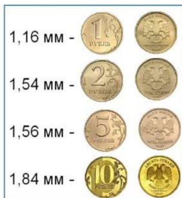
Рис. 4. Освоенные толщины холоднокатаной ленты для изготовления монетных заготовок Fig. 4. Mastered thicknesses of cold rolled strips for manufacturing coin blanks
