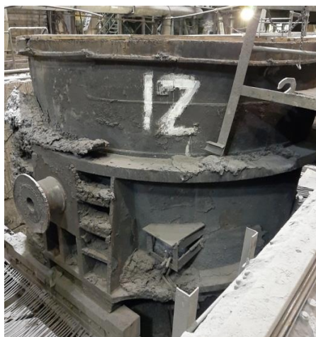
Рис. 3. Общий вид ковша сталеразливочного Fig. 3. General view of the steel ladle
