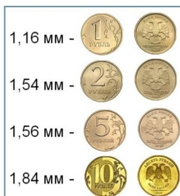
Рис. 4. Освоенные толщины холоднокатаной ленты для изготовления монетных заготовок
