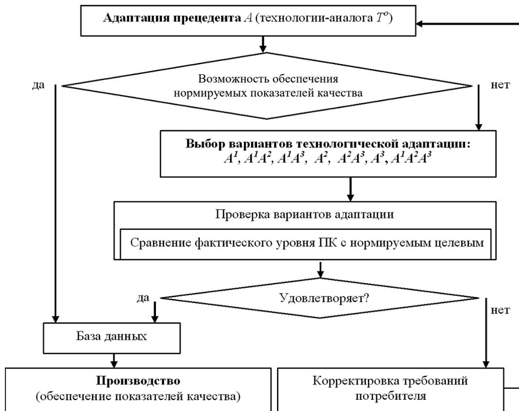
Рис. 2. Алгоритм адаптации прецедента в условиях технологической адаптации показателей качества
