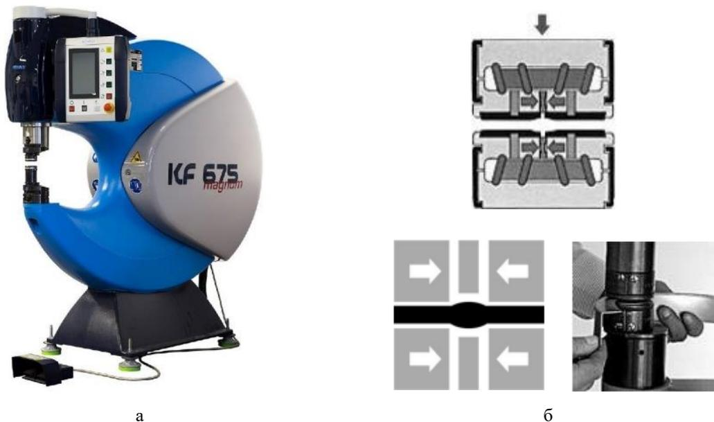
Рис. 5. Крафт-формер Eckold KF 675 (а), схема посадки ребер инструментом Eckold (б)
