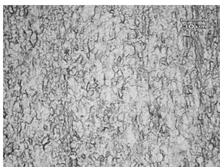
Рис. 7. Структура исходного образца сплава ОТ4-1 при температуре 20°C до нагрева под проведение осадки с кручением, увеличение \times 100 Fig. 7. The structure of the initial sample of alloy OT4-1 at 20°C before its heating for upsetting with torsion, \times 100 magnification
