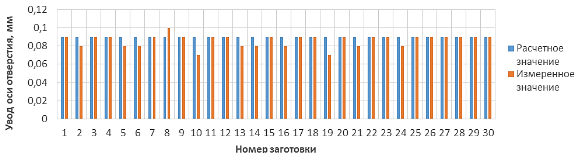
Рис. 10. Результаты измерений увода оси отверстия после сверления сверлом диаметром 2,5 мм (сталь ШХ15)
