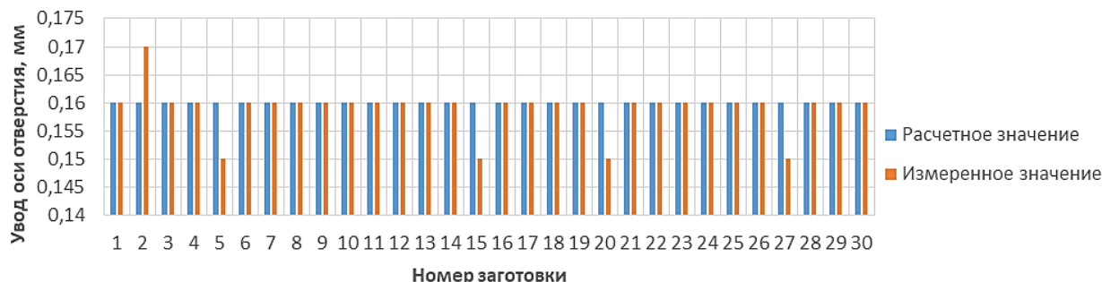
Рис. 8. Результаты измерений увода оси отверстия после сверления сверлом диаметром 5 мм (сталь 12X18H10T)
