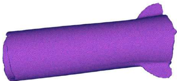
Рис. 3. Начальная геометрия трубной заготовки перед задачей в обкатную машину Fig. 3. Initial geometry of the tube workpiece before feeding to the burnishing machine
