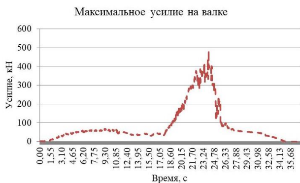
Рис. 6. График изменения усилия обкатки Fig. 6. Burnishing force behavior graph
