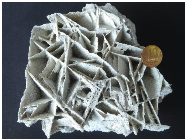
Рис. 1. Внешний вид шлака Ключевского завода с пластинчатыми кристаллами хибонита. Фото В.С. Пономарева
