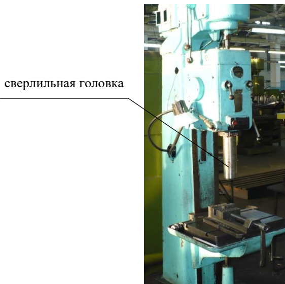
Рис. 7. Вертикально-сверлильный станок модели 2A125 с закрепленной на его шпинделе специальной сверлильной головкой Fig. 7. Vertical drilling machine model 2A125 with a special drilling head fixed on its spindle
