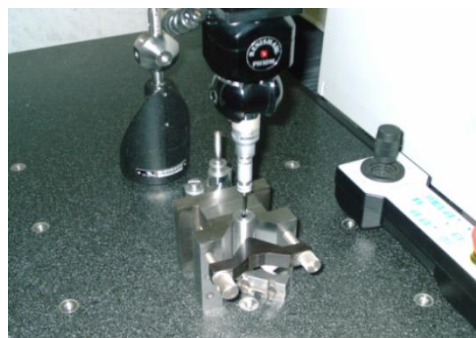
Рис. 2. Процесс замера детали на координатно-измерительной машине Global active
