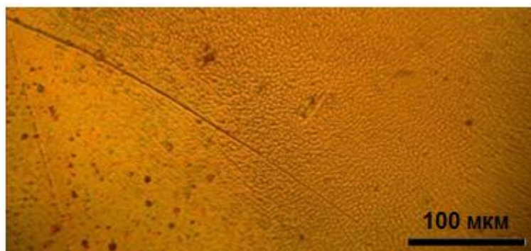
Рис. 5. Микрофотография облученной YBCO-пленки при плотности энергии 64 мДж/см 2 Fig. 5. The micrograph of the irradiated YBCO film at an energy density of 64 mJ/cm 2
