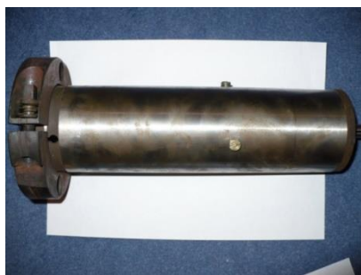
Рис. 3. Сверлильная головка с осевым перемещением Fig. 3. A drilling head with axial displacement
