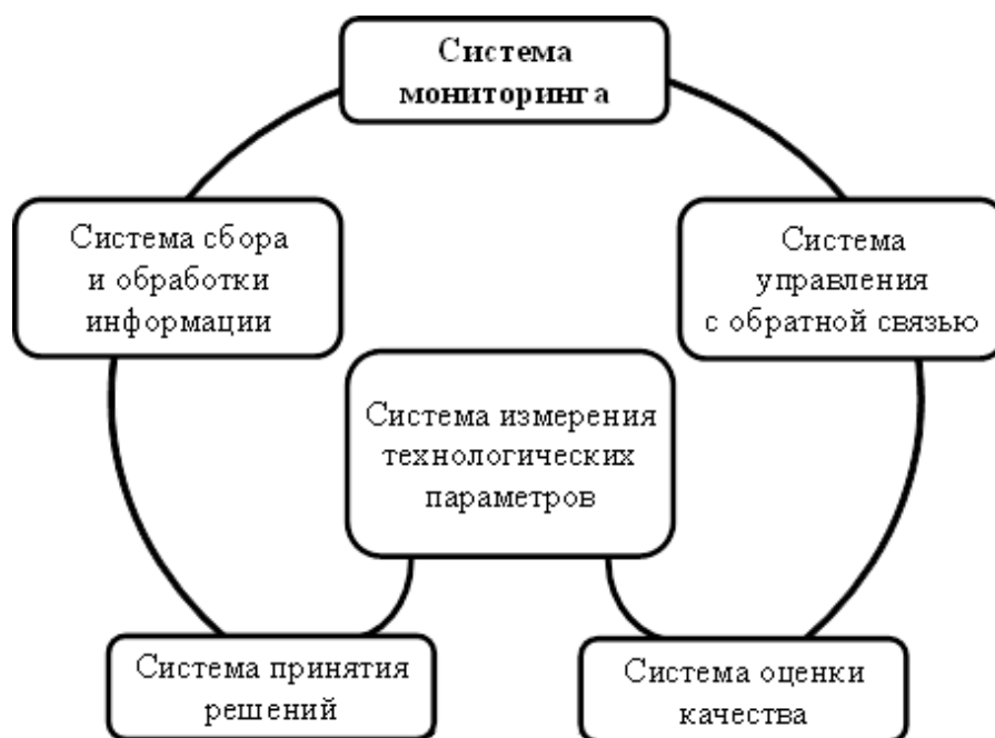
Рис. 3. Функциональная схема системы мониторинга Fig. 3. A functional diagram of the monitoring system
