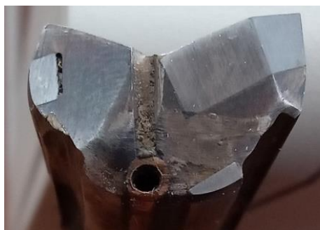
Рис. 6. Угловое расположение кулачков при \psi_1 \approx 105^\circ , \psi_2 \approx 215^\circ
