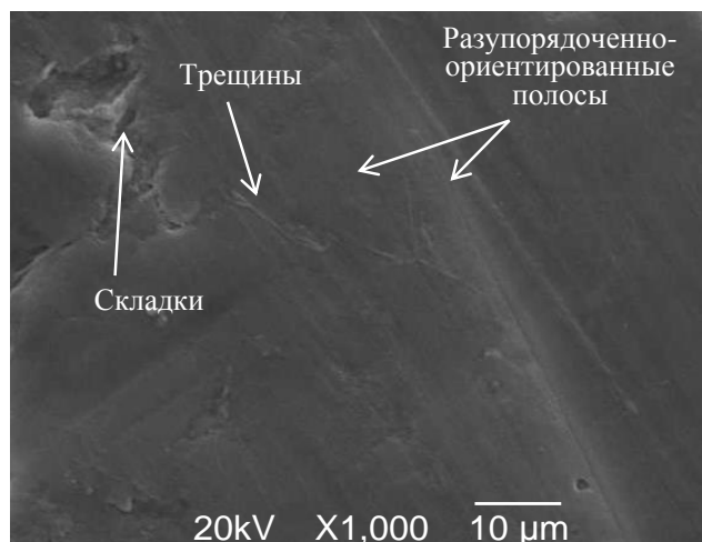
Рис. 1. Электронно-микроскопическое изображение поверхности образца №1 Fig. 1. Electron microscopic image of the surface of sample No. 1
